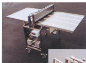
B900 ämnessmörjare är försedd med fällbara in- och utmatningsbord samt sväng- och låsbara hjul. Detta gör enheten flexibel och snabb att sätta i produktion.
